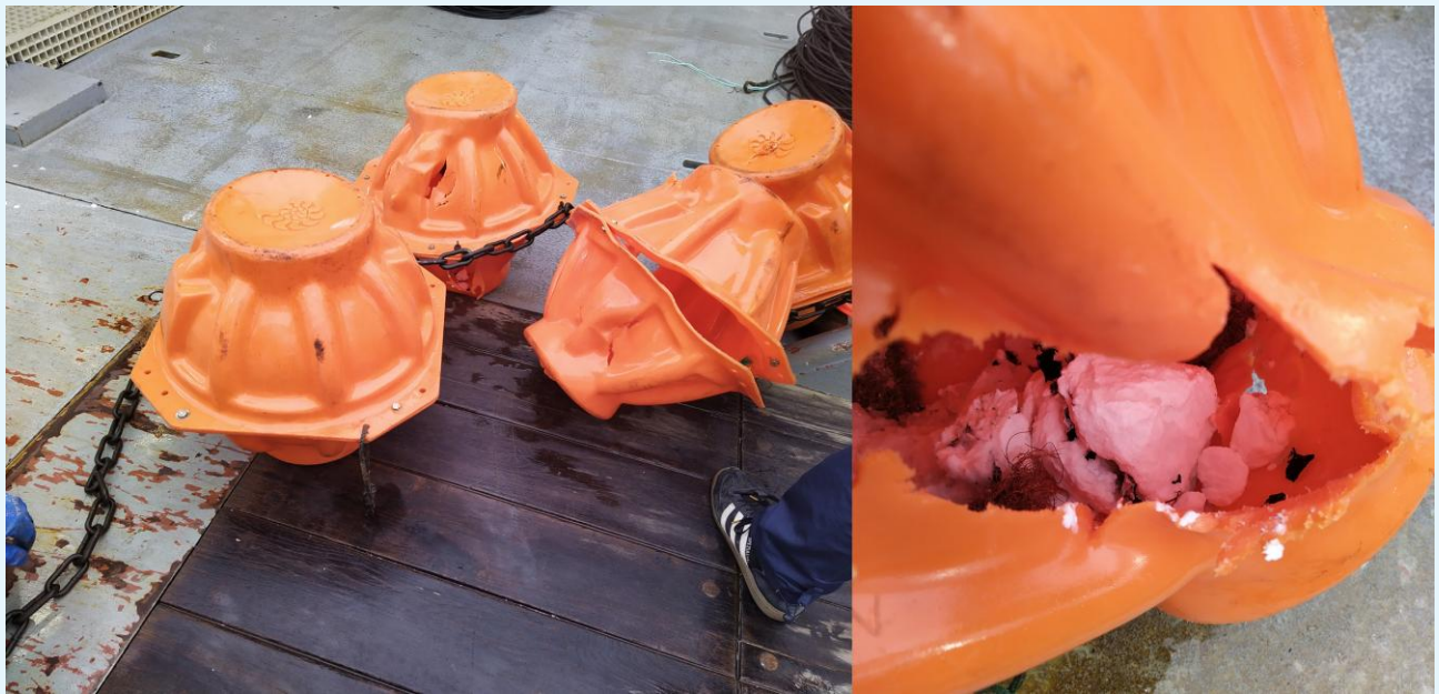
Mynd 2. Á tí djúpu fortøyingini norðanfyri vóru tær niðastu flotkúlurnar burtur. Helst eru tær imploderaðar (tað mótsatta av at explodera) og tað herdaða glasið pulvuriserað. Kúlurnar vóru á góðum 2400 metra dýpi, men eiga at tola eitt týst niður á 6000 m.
