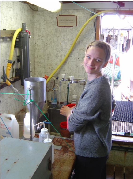
Nýggja útgerðin til at skilja fiskaegg frá djóraæti riggaði stak væl. Smáar luftbløðrur verða sprændar niður í traktina, sum prøvin er í – bløðurnar hanga fastar í djóraætinum, sum so flotnar upp, ímeðan fiskaeggini søkka til botns, og verða tappað av til nærri kanningar.
