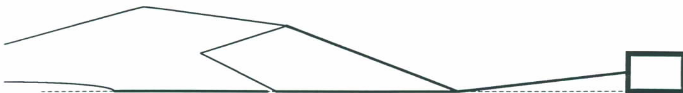
Mynd 1.3: Trol v.m.: Bacalao trol 360 meskar við 120 mm belli. 84" Thyborøn lemmar. 40 m breidlar og 40 m forleingarar.
