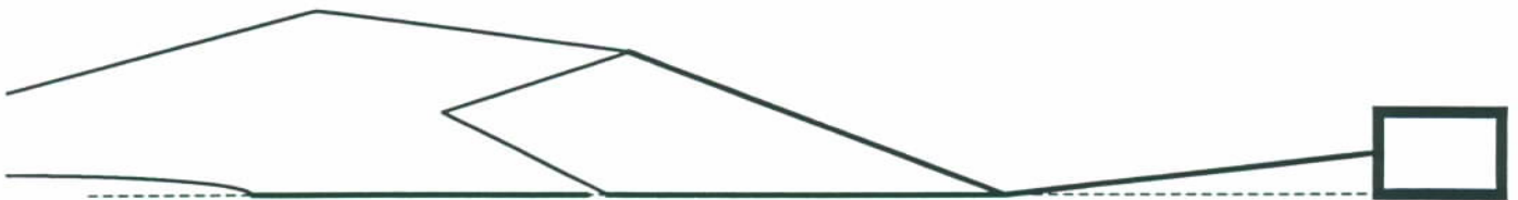
Mynd 5: Trol v.m.: Bacalao trol 360 meskar við 120 mm belli. 80" Thyborøn lemmar. 40 m 16 mm undirbreidlar og forleingarar. 40 m 10 mm yvurbreidlar.
