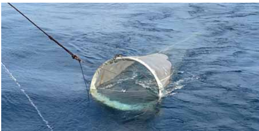
Mynd 4. MIK-glúpurin, sum varð nýttur at fanga toskalarvur við á tveimum túrum í mai. Meskavíddin í honum var 0,5 cm. Áðrenn mai var ein minni glúpur við minni meskavídd nýttur, og fyrst í juni varð ein størri MIK-glúpur við størri meskavídd nýttur. Hetta tí larvurnar vaksa skjótt í stødd og minka skjótt í tali.
