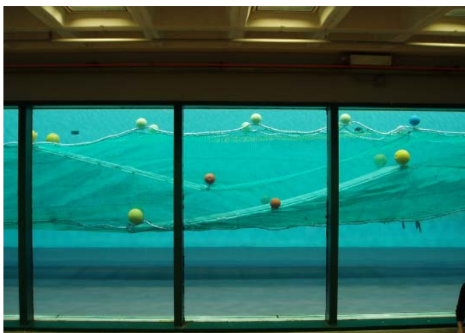
Fig. 4: Ristkonceptet i prøvetanken i Canada
