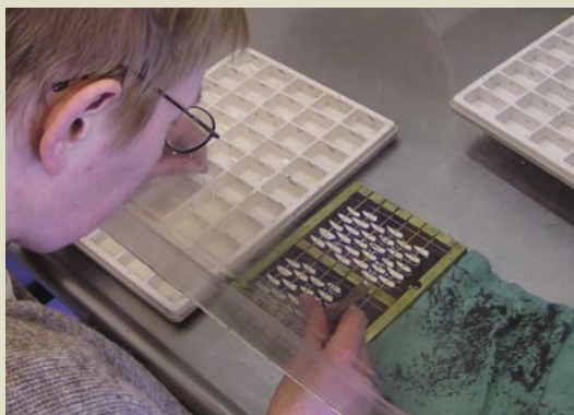
Í serligum rúmi við luftútsúgving verða nytrurnar stoyptar inn í ein soartan plastikkblokk.
