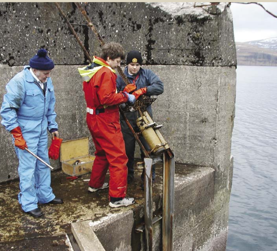
Mynd 4. Hitamátararnir við Oyrargjógv verða skiftir. Mátararnir eru heftir í eina rammu, ið er fest í keiina við Oyrargjógv.
