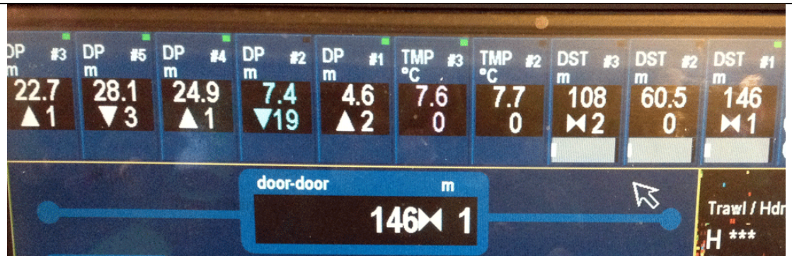
Mynd 2. Mátíngarnar á Scanbas eindini á brúnni. Hvørt vindeyga vísir mátingina frá einum av sensorunum. Her síggjast allar mátingarnar: 5. dýpi-, 3. avstand- og 2. hitamátingar. Talvan niðanfyri lýsir ymisku parametrarnar.
